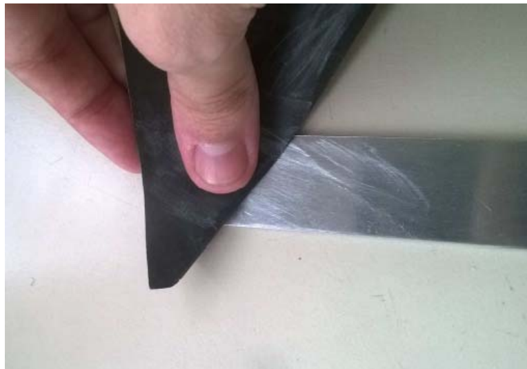
Figura 31 - Preparação de Superfície por lixamento
