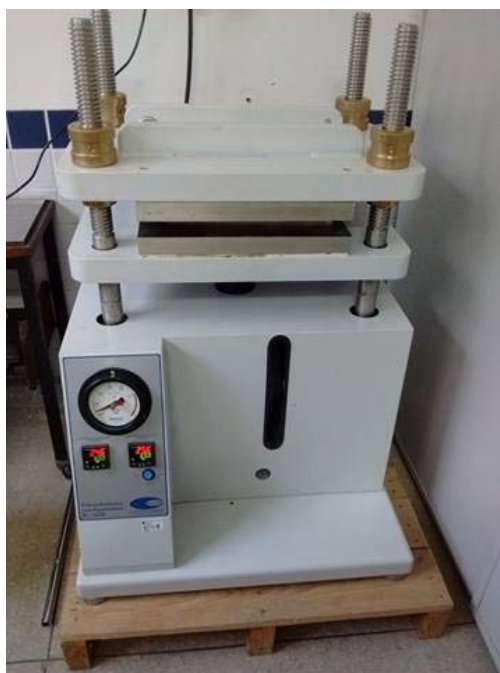
Figura 44 - Prensa hidráulica com aquecimento do LADES
