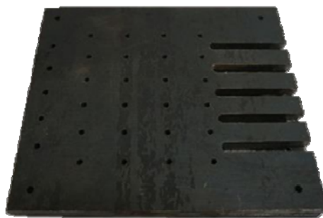
Figura 37 - Molde Usado para a Produção de Juntas Coladas
