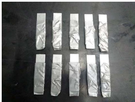
Figura 33 - Preparação para o jateamento
