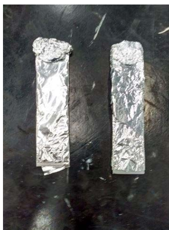
Figura 35 - Proteção contra oxidação com papel alumínio
