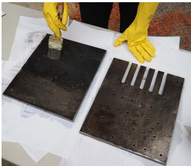
Figura 39 - Aplicação do agente desmoldante em local aberto
