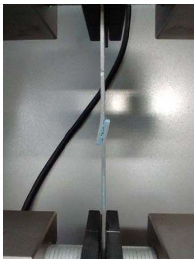
Figura 52 - Chapa deformada plasticamente durante o ensaio de tração.
