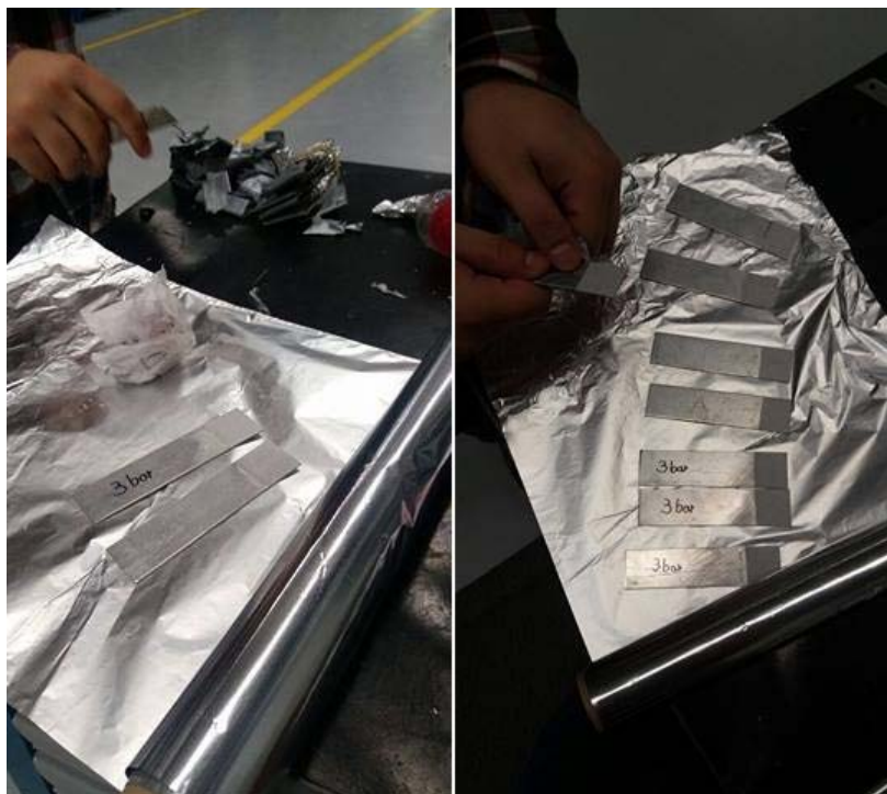
Figura 34 - Remoção dos invólucros e limpeza química
