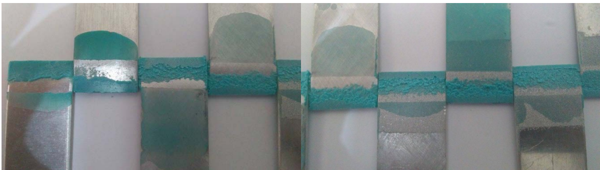
Figura 55 - Evolução do modo de ruptura em função da preparação superficial
